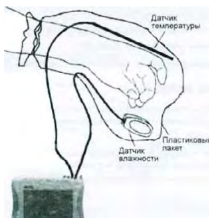
Рис. 17. Схема экспериментальной установки терморегуляции кожи
